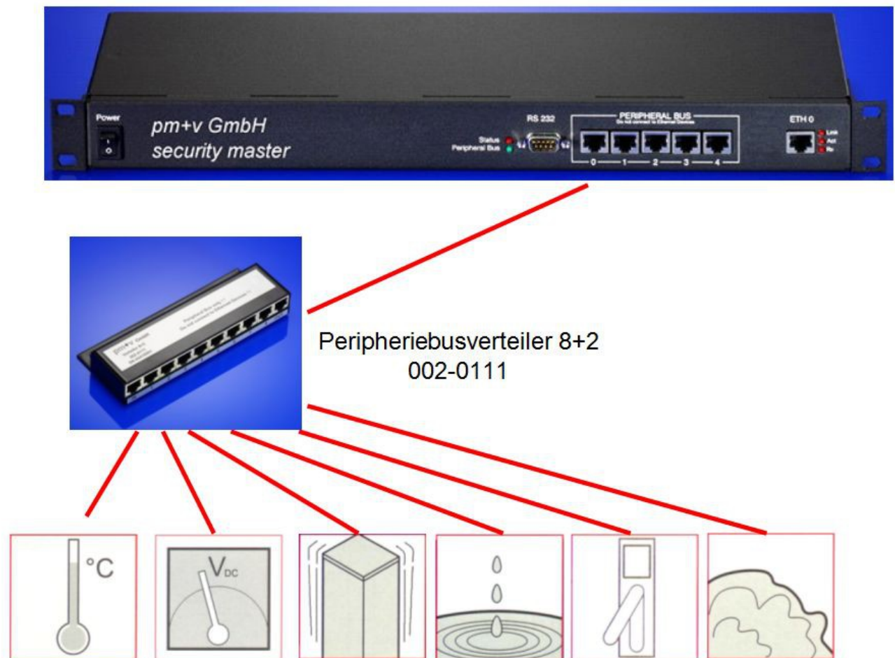
Anschluss der Peripherie mittels Peripheriebusverteiler an den security master .
